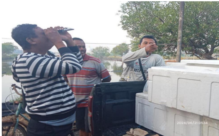
Gambar 12 Pengecekan salinitas dengan menggunakan refractometer
